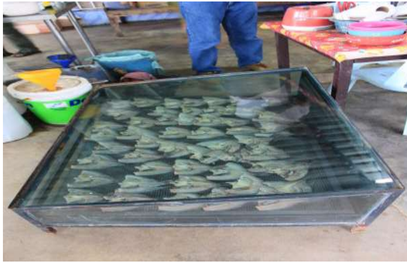
ภาพที่ 4.14 ตู้อบพลังงานแสงอาทิตย์ อุปกรณ์ประหยัดพลังงาน
