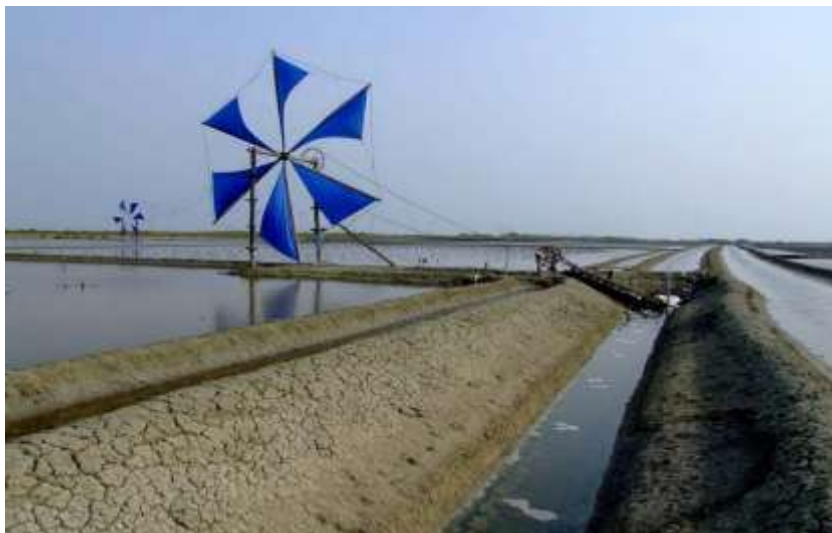
ภาพที่ 4.13 กังหันลมช่วยสูบน้ำเข้านาเกลือแทนเครื่องยนต์ดีเซล
