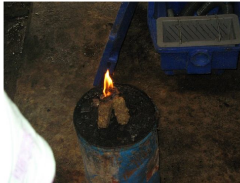
ภาพที่ 4.4 ก้อนถ่านที่ได้จากการผสมไขมันจากถังดักไขมันกับเศษใบไม้
