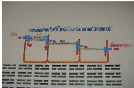
ภาพที่ 4.8 การติดตั้งถังดักไขมันในโรงเรียนแก่ง “วิทยสภารว”
