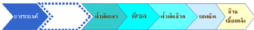
ภาพที่ 2.1 หลักการของกระบวนการไพโรไลซิส
