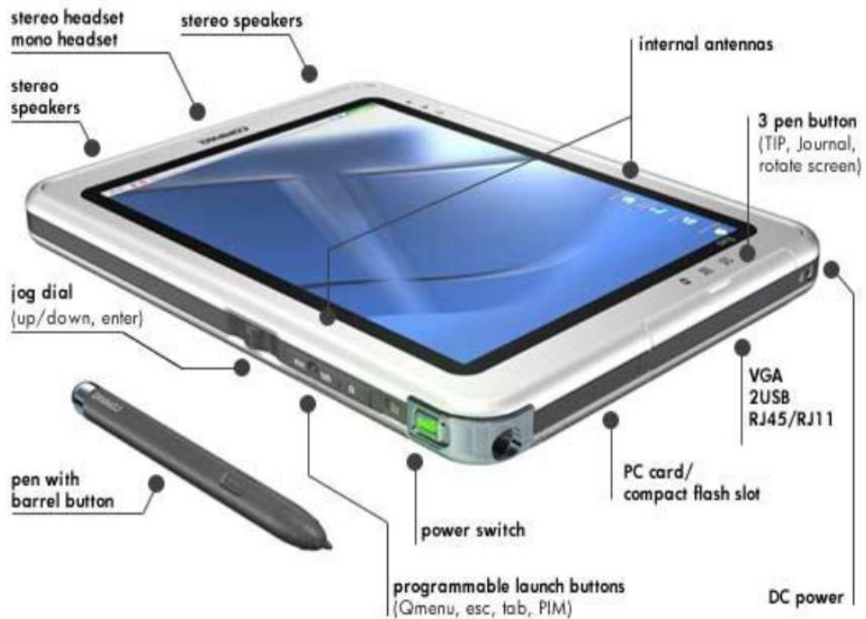
ภาพที่ 2.1 รูปแบบโครงสร้างภายนอกของแท็บเล็ตทั่วไป แหล่งที่มา: สำนักงานคณะกรรมการการศึกษาขั้นพื้นฐาน, 2555.
