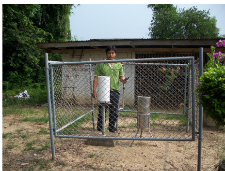
ภาพที่ 4.1 สภาพการสำรวจตำแหน่งทางภูมิศาสตร์สถานีวัดน้ำฝน ด้วยเครื่อง GPS Receiver
